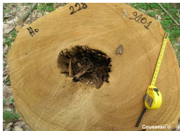
Figure n°84 : Pourriture de cœur se propageant jusqu' 80 cm
