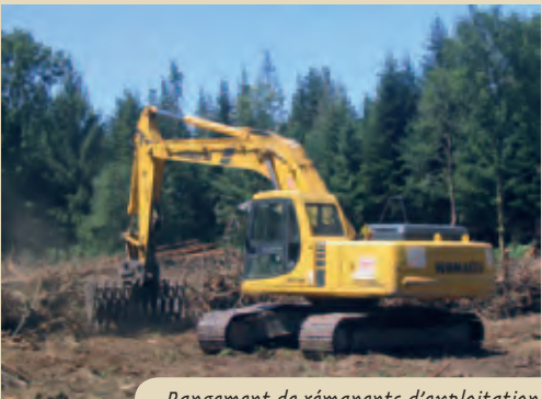
Rangement de rémanents d'exploitation d'épicéas réalisé en période sèche avec un matériel adapté (râteau)
