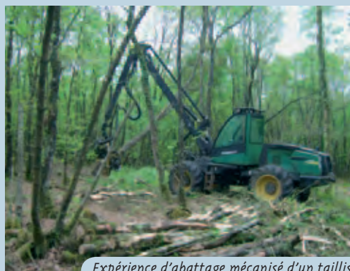
Expérience d'abattage mécanisé d'un taillis
