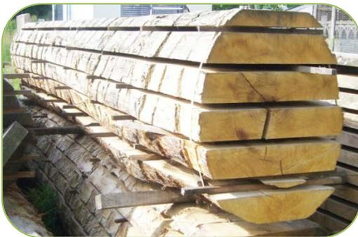
A gauche un plot de Châtaignier, à droite des avivés pour la fabrication de bardage ou de lame de terrasse.
