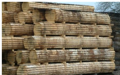
FIGURE 10 SCIAGE 1 ER CHOIX POUR PLOTS D'EBENISTERIE
