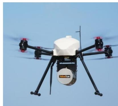
Photo 4 : Drone Xena Surveyor (crédit photo YellowScan)
