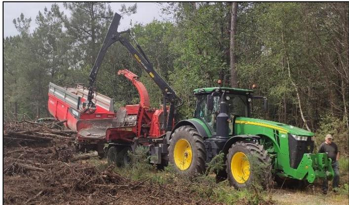
*Figure 4 : Desserte fonctionnelle permettant le broyage et le chargement des plaquettes*
