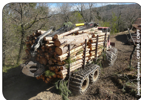
Porteur équipé d'un "kit chenille" autour des roues pour améliorer la portance en milieu fragile
