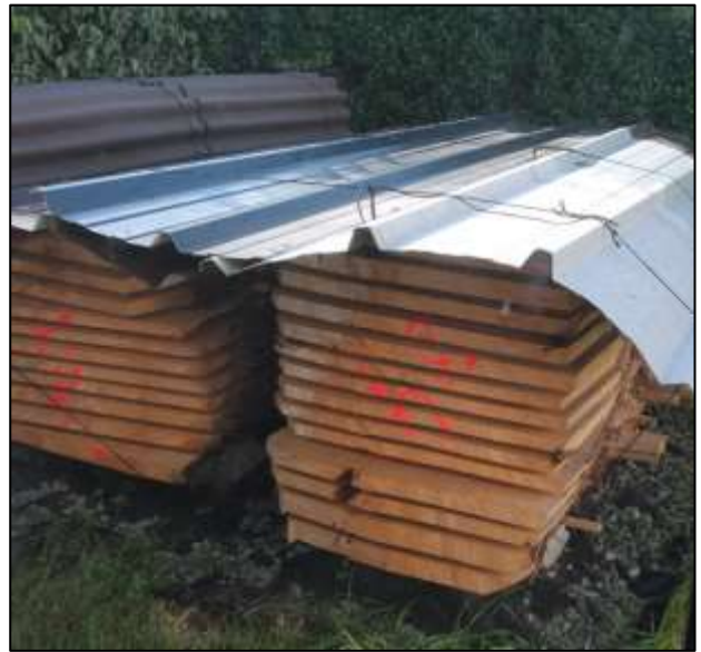
Séchage du bois à l'aire libre et protégé des intempéries par des tôles ondulées
