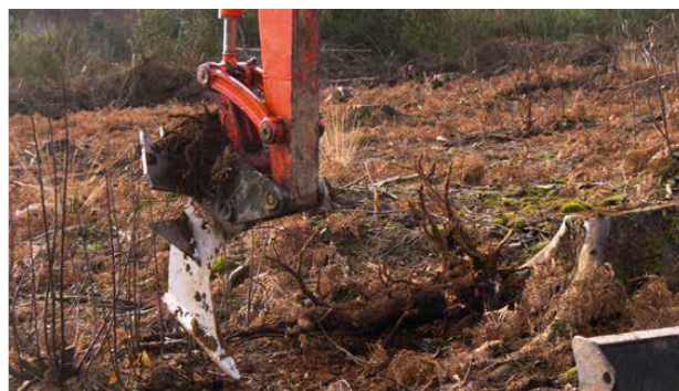
Création d'un potet travaillé au culti sous-soleur (Xavier Grenié © CNPF)
