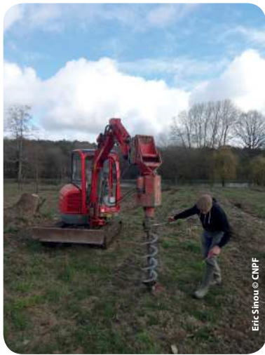
Tarière hélicoïdale sur mini-pelle.
