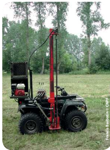
Tarière montée sur quad.
