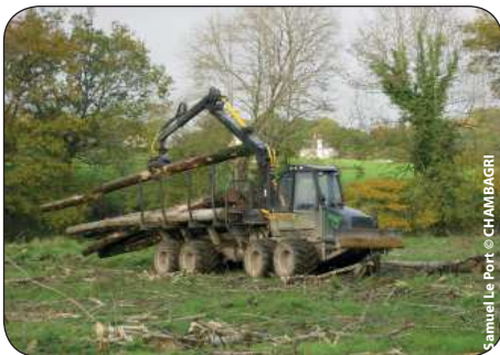
Débardage à l'aide d'un porteur
